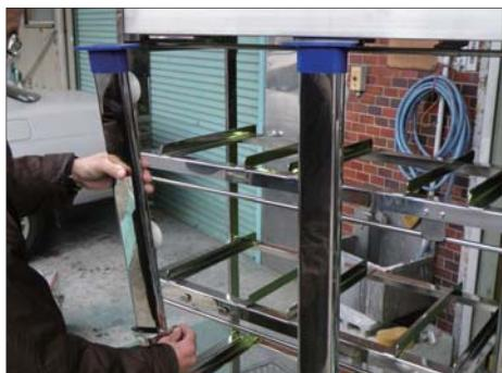
縦型配列R付槽円排気管分解作業
