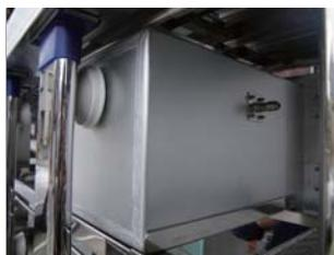
排気ディスコフィルターはシリコン製吸盤と密着してセット
